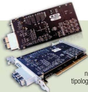
**HS1760/MIL-STD-1760E**, per bus MIL-STD-1760E e per i nuovi bus HS1760 secondo SAE AS5653. 2 porte su rame o fibra ottica; bus-monitoring, network-controller / terminal, nelle diverse tipologie di connessione.
