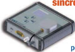
Alimentati a batteria interna forniscono in uscita il **codice IRIG-B** sincronizzato GPS, **1 PPS** e il codice seriale **NMEA 183** con tempo UTC e **dati di posizione**. Includono un ricevitore GPS a 24 canali che acquisisce tutti i satelliti in vista; nel caso in cui si perda la sincronizzazione GPS il tempo è mantenuto dall'orologio interno.
