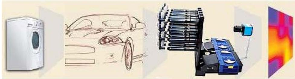
**siCamera** è un'innovativa "videocamera acustica" per l'analisi del suono che consente di **osservare e filmare il flusso sonoro** su di una superficie trasparente sovrapposta all'immagine dell'oggetto in esame, rilevata da una videocamera convenzionale.
