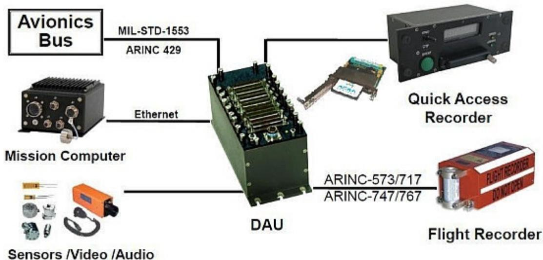
*Esempio di FDAU in front-end ad un FDR (Crash Protected) con QAR opzionale su Memoria CompactFlash interna o su Registratore IP stand-alone.*
