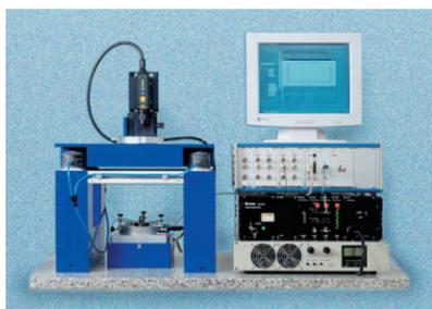
**Sistema di calibrazione primario con sensore di riferimento laser interferometrico; secondo ISO 16063-11.**
