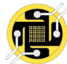
Estensimetro biassiale ultra miniatura 0^\circ/90^\circ (ingrandito di 10 volte)
