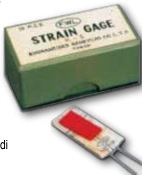
Una delle prime confezioni di estensimetri a filo introdotti da KYOWA nel 1949
