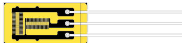
Estensimetro biassiale ortogonale a \frac{1}{2} ponte (ingrandito di 7,5 volte)
