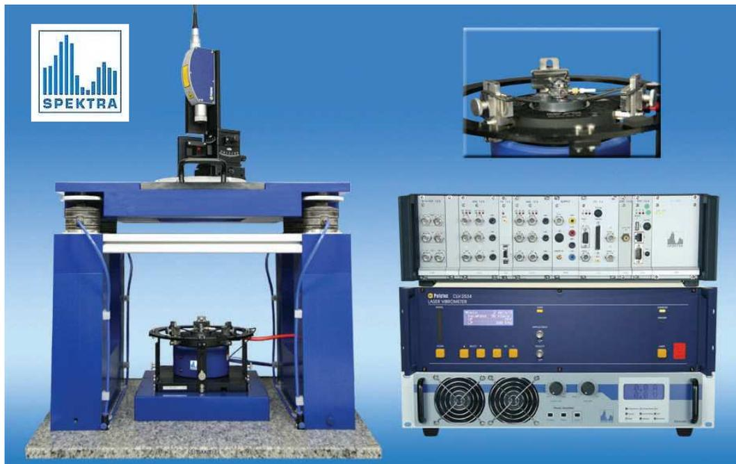
*Sistema di calibrazione primario con sensore di riferimento laser interferometrico; secondo ISO 16063-11.*
